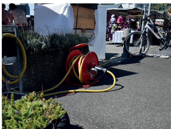
Kabelrolle mit Traggestell aus Stahlrohr
